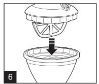
确保带机盖和电机机身完全盖紧冷冻碗。将插头插入插座。将 开关按至开 (I)。
