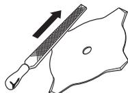
Maintenir un avoyage correct de la lame d'éclaircissage! Suivre nos instructions et utiliser le gabarit d'affûtage recommandé. Une lame d'éclaircissage mal affûtée
