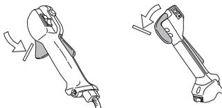
Appuyer sur le blocage de l'accélération et vérifier qu'il revient de lui-même en position initiale quand il est relâché.
