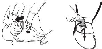
S'assurer du bon positionnement des bretelles du harnais. Quand le harnais et la machine sont ajustés, contrôler le bon fonctionnement du dispositif de libération rapide du harnais.
