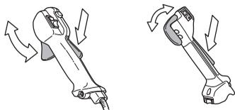
Voir le chapitre Démarrage. Démarrer la machine et donner les pleins gaz. Relâcher l'accélérateur et s'assurer que l'équipement de coupe s'arrête et qu'il reste immobile. Si l'équipement de coupe tourne lorsque l'accélérateur est au régime de ralenti, contrôler le réglage du ralenti du carburateur. Voir le chapitre Entretien.
