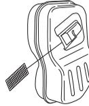
**REMARQUE!** Ne jamais utiliser la machine si le silencieux est en mauvais état.
