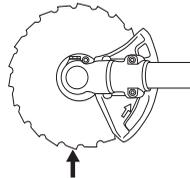
Les dents de la lame d'éclaircissage risquent de causer des blessures aussi bien lors du serrage que du desserrage de l'écrou de la lame. Veiller à ce que la main soit toujours protégée par le protège-lame lors de ces interventions. Toujours utiliser une clé à douille munie d'un manche assez long. La flèche sur l'illustration indique la zone dans laquelle la clé doit être utilisée, aussi bien pour serrer que pour desserrer l'écrou.
