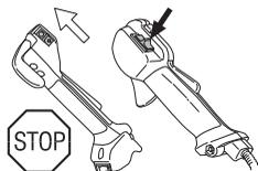
Mettre le moteur en marche et s'assurer qu'il s'arrête lorsque le bouton d'arrêt est amené en position d'arrêt.
