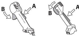
Vérifier d'abord que la commande de l'accélération est bloquée en position de ralenti quand le blocage de l'accélération est en position initiale.
