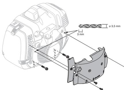
**IMPORTANT!** Quand la température repasse au dessus de 5°C, la machine DOIT être restaurée à sa version d'origine. Sinon il y a risque de surchauffe avec pour conséquence de graves dommages au moteur.
