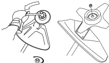
L'usure du verrouillage nylon du contre-écrou ne doit pas être telle qu'il peut se visser à l'aide des doigts. Le verrouillage doit résister à 1,5 Nm au moins. Remplacer le contre-écrou après une dizaine de serrages.
