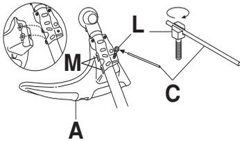
crochets du support de tôle (M). Plier la protection autour du tube de transmission et serrer avec la vis (L) du côté opposé au tube de transmission. Utiliser la goupille de blocage (C). Placer la goupille de blocage dans la rainure de la tête de vis et serrer. Voir fig.
