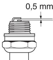
**REMARQUE!** Toujours utiliser le type de bougie recommandé! Une bougie incorrecte peut endommager le piston/le cylindre. S'assurer que la bougie est dotée d'un antiparasites.
