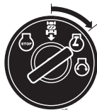
MOTOR EN POSICIÓN "ON" (OPERACIÓN NORMAL)
