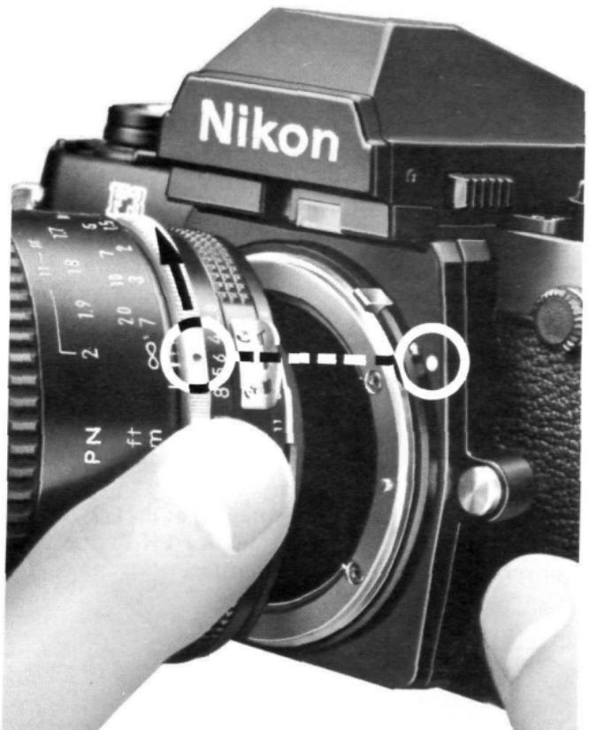
Tome el objetivo por su anillo de montaje. Coloque el objetivo en la montura de bayoneta de la cámara, alineando la referencia de abertura situada en el objetivo con la referencia de montaje de la cámara y gírelo en sentido contrario a las agujas del reloj hasta que quede asegurado en su lugar.
