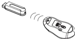
3. Wanneer u de verbindingsknop van de receiver indrukt, licht de led in de receiver op. Zodra de verbinding tot stand is gekomen, dooft de led.
