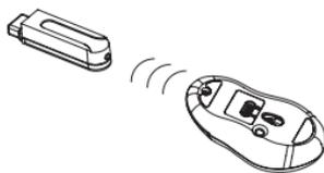
3. Premendo il pulsante di connessione del ricevitore, il LED al suo interno si accende. Non appena il collegamento è terminato, il LED si spegne.
