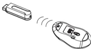
3. Après avoir appuyé sur le bouton « Connect » du récepteur, le témoin lumineux à l'intérieur du récepteur s'allume. Dès que le lien est réalisé, le témoin lumineux s'éteint.
