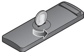
2. Retire la tapa e inserte la nueva pila (CR2032 o DL2032) con la cara plana hacia arriba y el símbolo más (+) a la vista.
