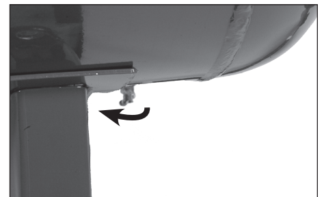
Figura 16 - Drenaje manual del tanque
