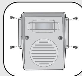
Monter le détecteur de mouvement infrarouge passif horizontalement sur une surface ferme à une soixantaine de centimètres (quelques pieds) du sol et à moins de 300 m (1000 pi) de la station de base. Il doit être possible de tourner le détecteur selon le besoin.
