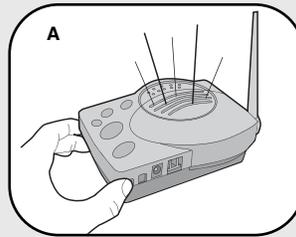
**A** Vérifier que la station de base et le détecteur de mouvement PIR sont proches l'un de l'autre. Appuyer momentanément sur la touche d'apprentissage de la station de base. L'avertisseur doit émettre un son.
