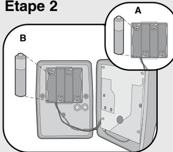
**A** Installer les 4 piles alcalines AA (pas fournies) (des piles au lithium sont recommandées pour les environnements froids).
