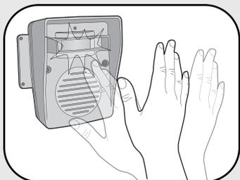
Faire un essai du détecteur de mouvement PIR en bougeant une main devant le détecteur. Le voyant d'essai doit clignoter après plusieurs secondes.
