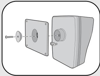
Attacher la boîte de détecteur de mouvement infrarouge passif sur la plaque de montage avec la vis argentée. Serrer la vis jusqu'à ce que le détecteur de mouvement PIR reste en place quand ajusté.
