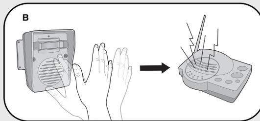
**B** Dans les 5 secondes suivantes, déplace une main devant le détecteur de mouvement PIR. Le voyant d'essai s'allume et la station de base est activée, avec de la statique et du feedback, après plusieurs secondes.
