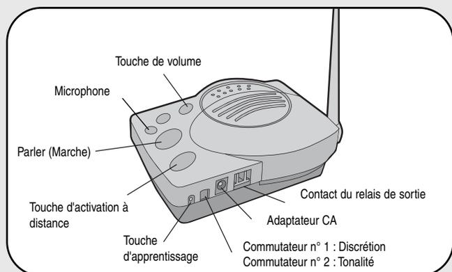
**Caractéristiques de l'interphone :** Quand le détecteur de mouvement infrarouge passif a détecté un mouvement, la station de base permet d'écouter pendant 10 secondes par l'intermédiaire du détecteur de mouvement infrarouge passif. Pour parler à la personne à l'autre extrémité, appuyer sur la touche pour parler et parler, relâcher pour écouter.
