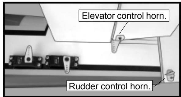
**ELEVATOR-RUDDER PUSHROD INSTALLATION.**
