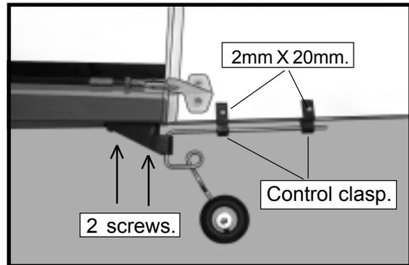
**INSTALLING TAIL STRUT SYSTEM.**
