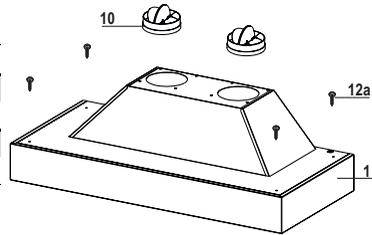
Le support de la hotte doit être en mesure de soutenir 40 lbs. (18,1 Kg) pour le modèle 36" ou 55 lbs. (25 Kg) pour le modèle de 48".
