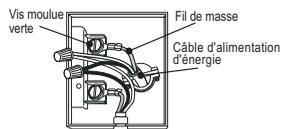
10. Insérer les vis à travers le support et visser dans les trous profilés de la hotte. Serrer les vis fermement.
